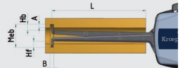
Meb Messbereich A Nuttiefe B Nutbreite
